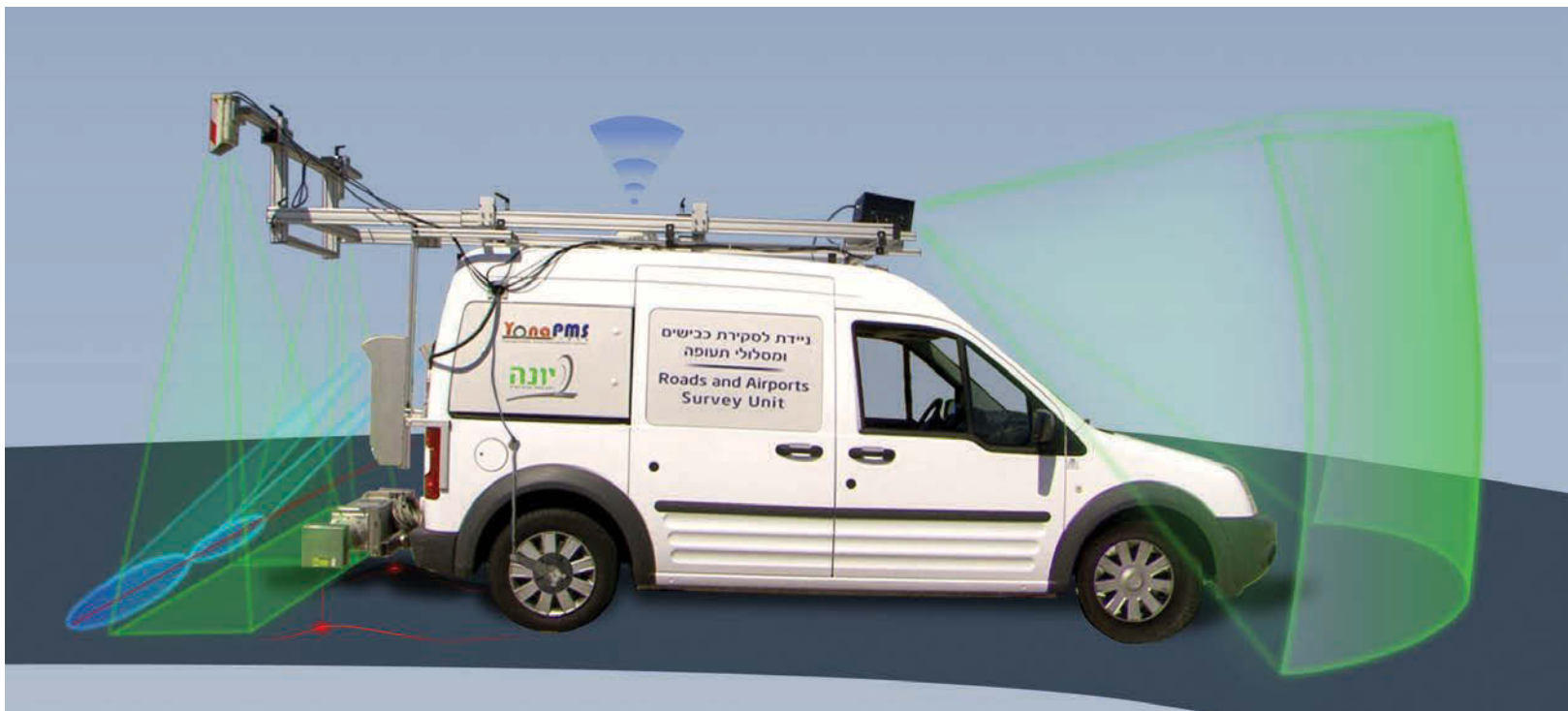
Vehículo multifunción, equipado con instrumentos de levantamiento de datos en el campo
